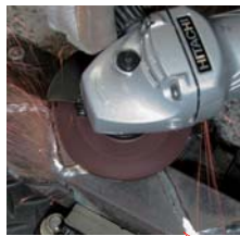
従来のオフセット型 (溶接ビード面が見えない)
