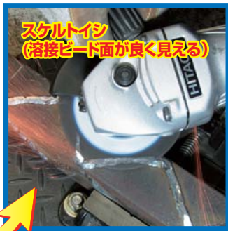
BF29形状で大きい接触面積 (スケルトイシ)
